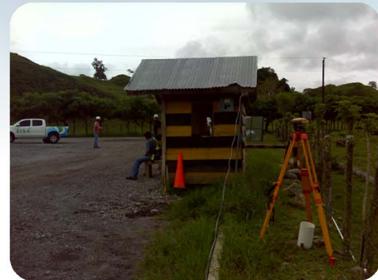
Traslado de punto al área de la garita de seguridad de Presa Pando.
